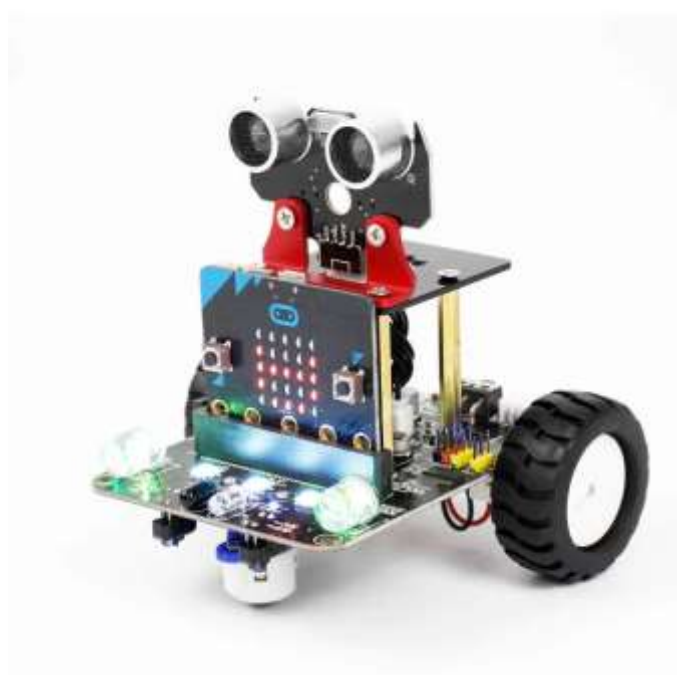
Figura 4 – Yahboom micro: macchina robot intelligente bitbot con IR e APP per Micro:bit V2/V1.5 (Fonte: https://category.yahboom.net/products/bitbot )
